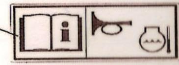
**Bei ertönen der Warnhupe ist die Maschine überhitzt. Entfernen Sie den Schmutz vor dem Kühler und aus dem Luftfilter.**
